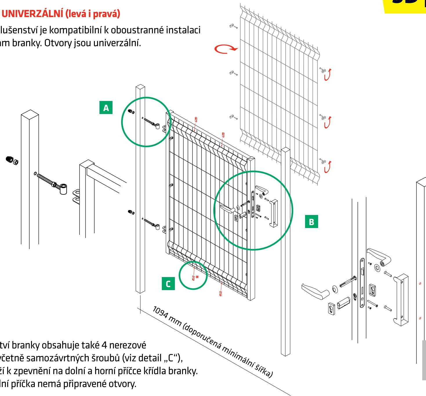
\* Příslušenství branky obsahuje také 4 nerezové příchytky včetně samozávrtých šroubů (viz detail „C“), které slouží k zpevnění na dolní a horní příčce křídla branky. Horní a dolní příčka nemá připravené otvory.
